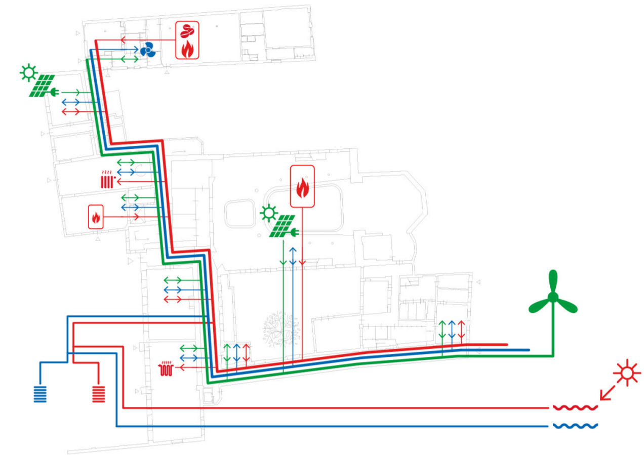
Naar een energieneutraal complex, energiecoöperatie Tivoli. Diverse functies stemmen energievraag met elkaar af in Smart Grid.
