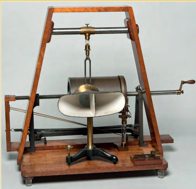
In 1866 vertoonde F.C. Donders aan leden van het Provinciaal Utrechtsch Genootschap de noematachograaf met bijbehorende hoorn, de phonautograaf. Het apparaat was bedoeld om prikkelverwerking in de hersenen te meten. Eén proefpersoon produceerde een klank als 'Ki', de andere moest die zo snel mogelijk herhalen. Vervolgens mocht de eerste kiezen tussen 'Ki' en 'Ka', zonder dat de tweede wist wat hij te horen zou krijgen. Met het verschil in reactietijd tussen de twee experimenten kon Donders de tijd berekenen die het de hersenen kostte om een keuze te maken.
