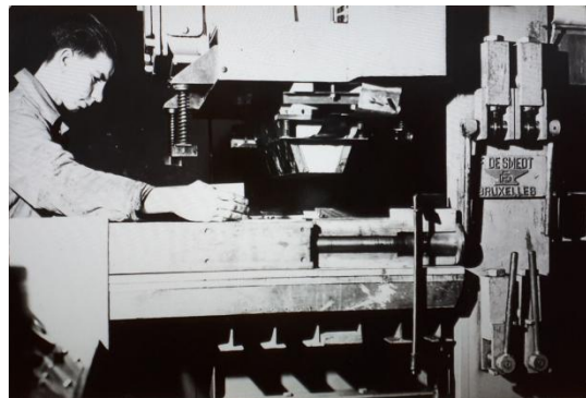
De ultramoderne, hoogfrequente buigmachine per 1950. Zichtbaar tussen de houten mallen zijn de verbingsbeugel van de stoel SB 02 (vooraan) en een triplex ladebakje (achteraan). →
