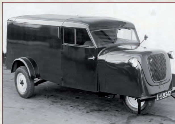
De Nemo was een driewielig vrachtwagentje met voorwielaandrijving. Er was weliswaar een markt voor dit soort miniwagens na de oorlog, maar de Nemo werd geen succes. Er werden uiteindelijk maar zo'n veertien of vijftien exemplaren verkocht.
