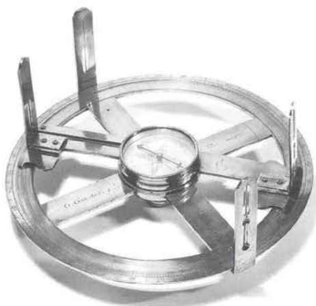
Hollandse cirkel 18e eeuw. Instrument voor landmeten. Bruikleen van Fundatie van Renswoude aan Utrechts Universiteitsmuseum. Foto Universiteitsmuseum.
