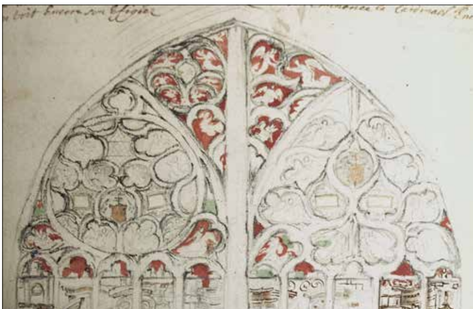
9 Top van het zuidelijke transeptvenster van de Sint-Janskerk in 's-Hertogenbosch met het oorspronkelijke maaswerk en restanten van gebrandschilderd glas. Uitsnede uit een anonieme tekening uit de late zeventiende eeuw in de collectie van de Raad van Adel, Brussel, inv. nr. 30, f. 113. Foto auteur.
