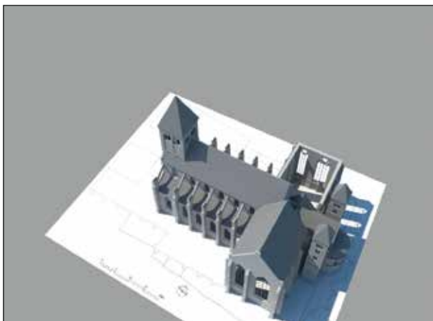
De Buurkerk met de vierde fase van het noordelijke transept, waarbij één travee van de noordelijke gevel en twee venstertraveeën van de westelijke gevel tot volle hoogte worden opgetrokken. Daan Claessen, 2017.
