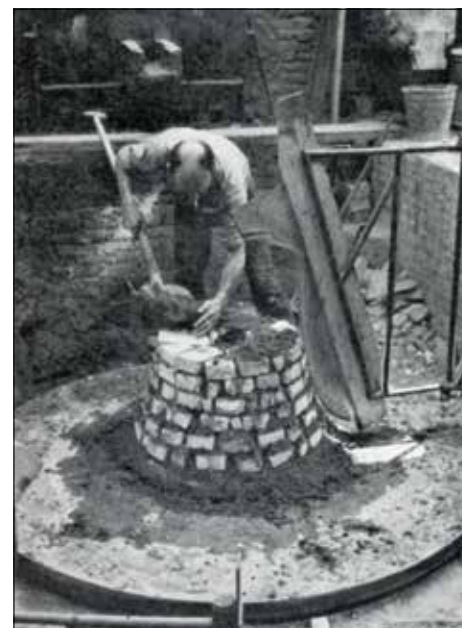
Aan een horizontale spil, met als bijnaam spit, werd de klokkenkern vormgegeven, zoals te zien valt in een tekening van Christoff Sesselschreiber uit 1524. Daaronder een moderne reconstructie. Tegenwoordig wordt een stenen aanzet gemaakt voor de kern. Lehr 1971, 49 en afb. 16.
