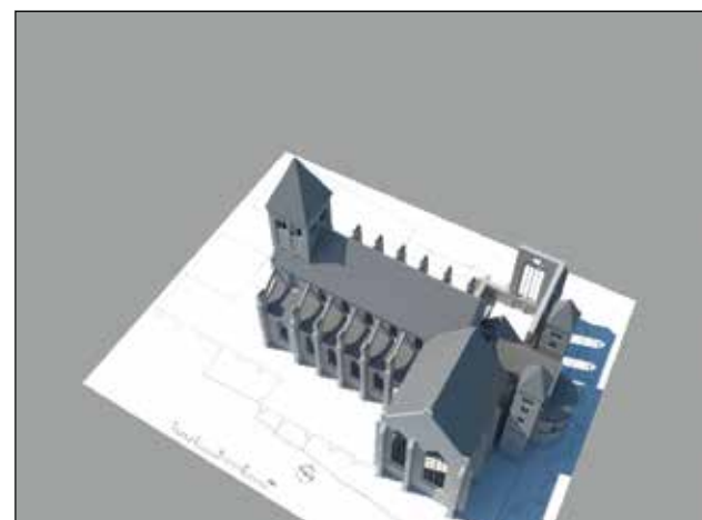
De Buurkerk met de derde fase van het noordelijke transept, waarbij één venstertravee van de oostelijke gevel en één travee van de noordelijke gevel tot volle hoogte worden opgetrokken. Daan Claessen, 2017.
