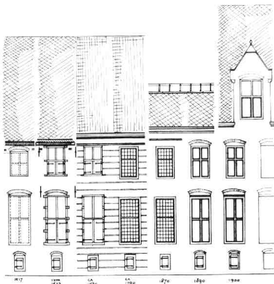
Afb. 51 Janskerkhof 3. Evolutie van de Statenkamer in doorsnede (oostmuur) en gevelaanzicht. Iedere travée vertegenwoordigt een nieuwe fase. Tek. A. F. E. Kipp.
