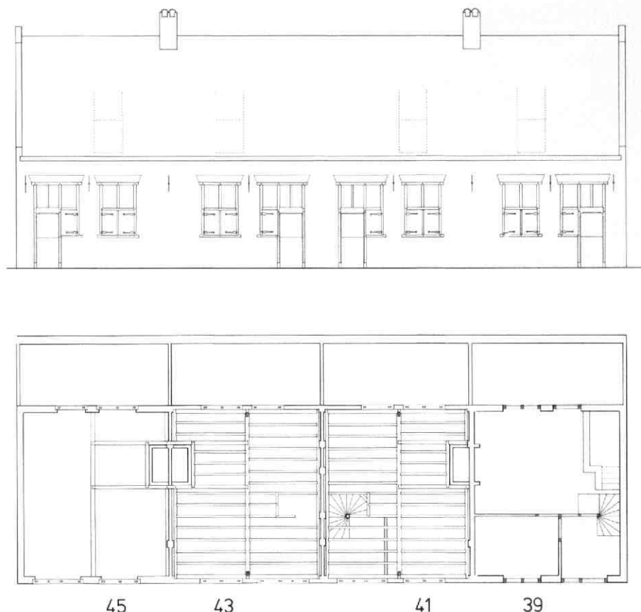
Afb. 31 Eligenstraat 39-45. Reconstructie van plattegrond en voorgevel omstreeks 1625. Tek. Kees Terhorst. Nr 39 is getekend op ca 1.50 m hoogte met indeling in halletje, voorkamertje, woonkamer en bedstede met keldertje. De andere huizen zijn op het niveau van de balklaag getekend met trapaveling en het in de moerbalken verankerde raamwerk waarin de rookkanalen zijn geklemd.
