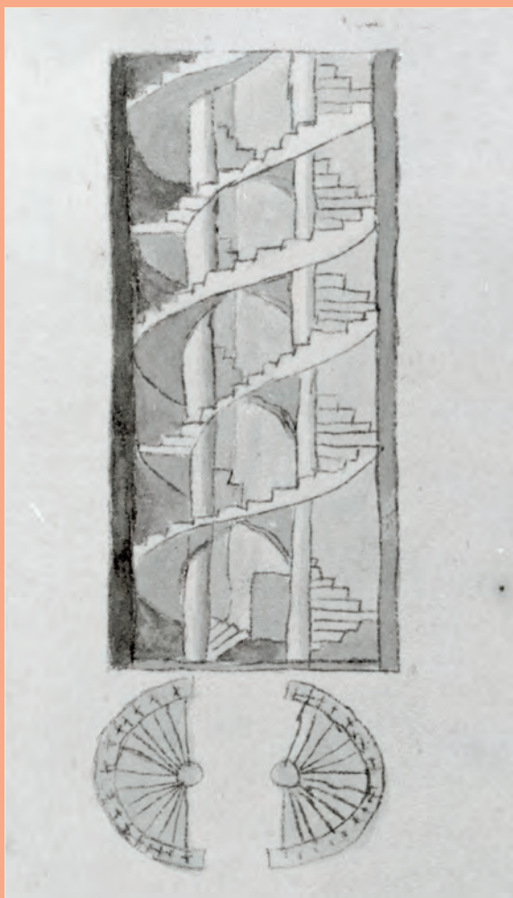
Afbeelding van de opengewerkte traptoren met de dubbele trap van de Domkerk te Utrecht. Fotoreproductie uit 1994 van een tekening van J.S. Marcus uit de 18e eeuw mogelijk naar een ouder voorbeeld. De dubbele wenteltrap was tussen de Bisschopsloge en het schip van de Dom uitgespaard in de zware, met een spits bekroonde steunbeer in de as van de zuidelijke pijlerreeks van het middenschip.
