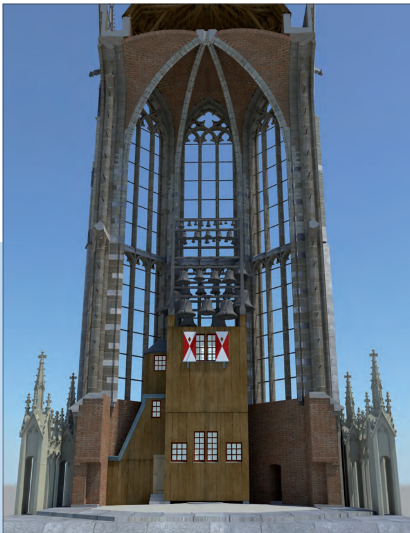
Reconstructie van de ijzeren klokkenstoel van Berent Hofsmid uit 1695 voor de beiaard met Hemony-klokken. De cabines voor het klavier en die voor de trommel waren al in 1642 gebouwd.
