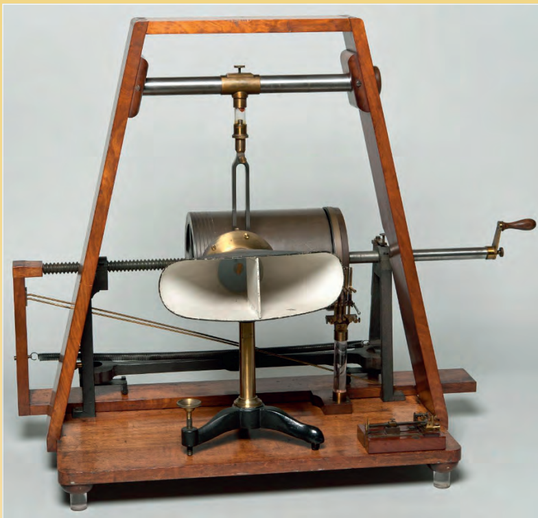
In 1866 vertoonde F.C. Donders aan leden van het Provinciaal Utrechtsch Genootschap de noematachograaf met bijbehorende hoorn, de phonautograaf. Het apparaat was bedoeld om prikkilverwerking in de hersenen te meten. Eén proefpersoon produceerde een klank als 'Ki', de andere moest die zo snel mogelijk herhalen. Vervolgens mocht de eerste kiezen tussen 'Ki' en 'Ka', zonder dat de tweede wist wat hij te horen zou krijgen. Met het verschil in reactietijd tussen de twee experimenten kon Donders de tijd berekenen die het de hersenen kostte om een keuze te maken.
