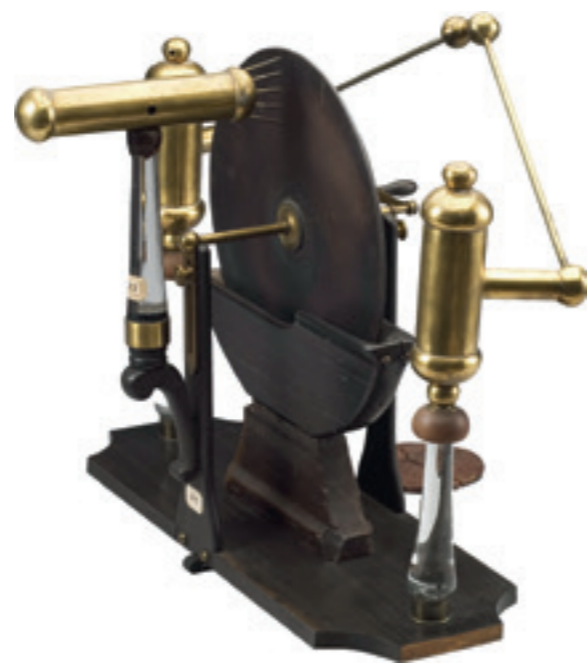
▲ Elektriseermachine van Martinus van Marum uit 1774, voorloper van de Grote Elektriseermachine in het Teylers Museum. TEYLERS MUSEUM
